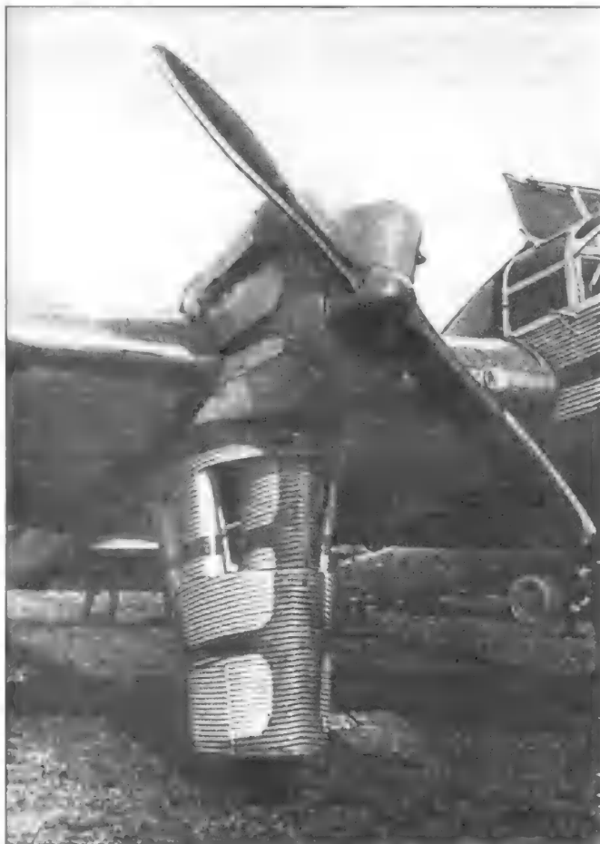
Г-37, вид спереди. Хорошо видны тоннели радиаторов в обтекателях стоек шасси.
